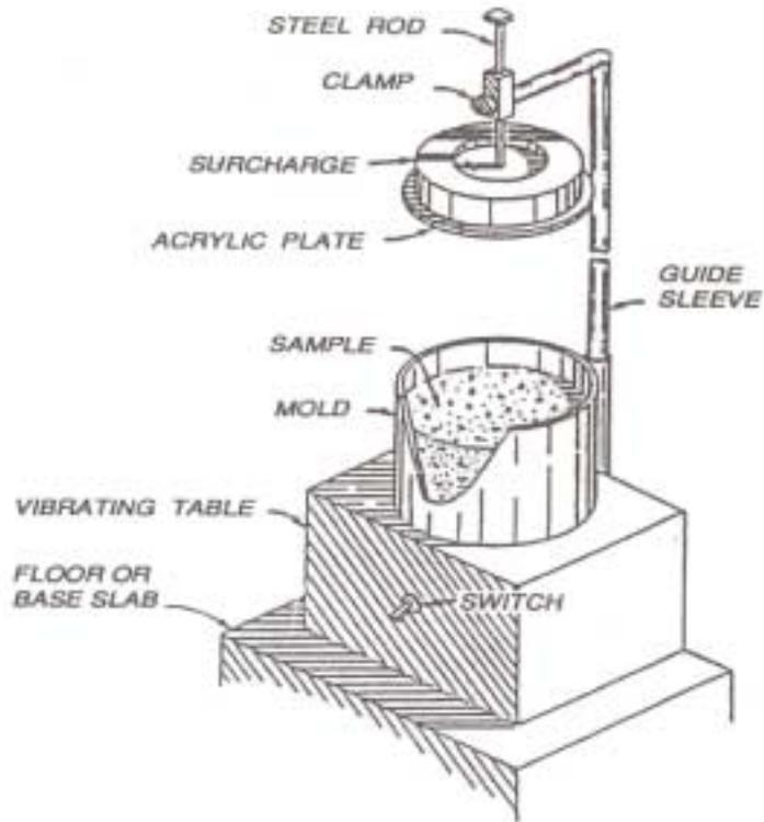
Fig. 1. Modified Vebe test apparatus
